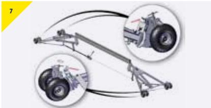
Wenn Sie eine Hebevorrichtung am Portal anbringen, befestigen Sie diese jetzt und bremsen Sie die Laufkatze mit dem Handrad.
