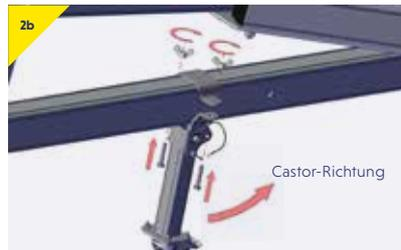
➤ Bewegen Sie die Radbaugruppe zur Verstrebung und montieren Sie sie so nah wie möglich an der Oberseite des Rahmenblechs. Verwenden Sie die mitgelieferten Schrauben und Flügelmutter, um die Montagehilfe an den Beinen zu befestigen.
