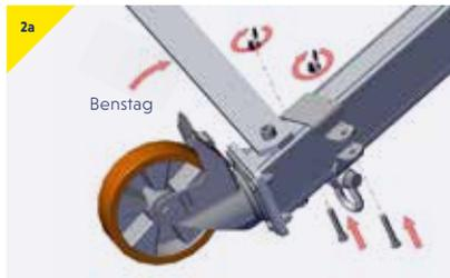
➤ Bewegen Sie die Schäkkelbaugruppe nach links, während sie nach innen zeigen, und bringen Sie sie so nah wie möglich am Holm an. Verwenden Sie die mitgelieferten Schrauben und Flügelmutter, um die Montagehilfe an den Beinen zu befestigen (eine an jedem Bein).
